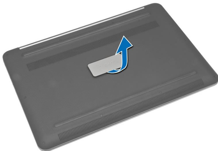
4. Remova os parafusos que prendem a tampa da base no computador. Levante e remova a tampa da base do computador.
